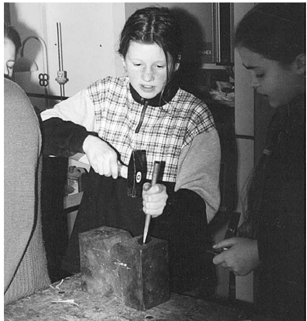
Bearbeitung von Blech mit Hammer und Meißel
